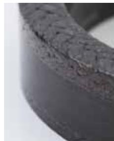
Bague composite constituée d'un anneau central de graphite expansé et de bagues tressées comprimées aux extrémités. L'ensemble assure une étanchéité parfaite sous 1000 bar.
