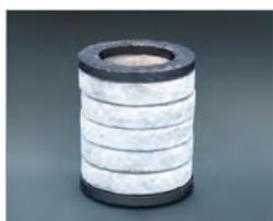
LATTYflon 3265 LM peut être montée en bagues d'étanchéité dans les montages mixtes avec LATTYgraf 6995 NG ou LATTYgraf 6988 EF comme bagues anti-extrusion, et répond aux exigences de la Norme ISO 15848-1, classe BH.
