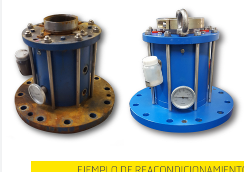
EJEMPLO DE REACONDICIONAMIENTO DE UNA CAJERA DE AGITACIÓN
