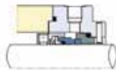
**LATTYseal B 18212** : cierre mecánico con resorte cilíndrico, independiente del sentido de rotación
