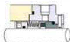
Se utiliza principalmente en fluidos viscosos a alta temperatura, hasta 220 °C y a más con juntas de grafito
