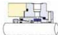
**LATTYseal B 17 B** : cierre mecánico con fuelle metálico soldado, independiente del sentido de rotación
